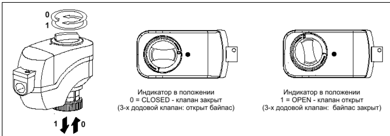
Рис. к – Настройка клапана управления расходом воды, подаваемой на конденсатор
